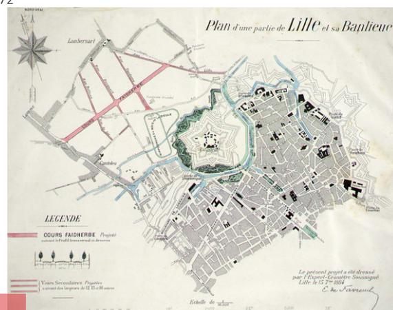
Projet du géomètre E. de Favreuil d'un cours Faidherbe à Lambersart, avec une chaussée centrale, deux latérales et 4 rangés d'arbres pour 42 mètres de large, daté du 15 septembre 1884.
