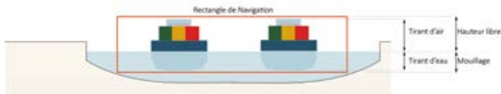
Principes déterminant le gabarit d'une voie d'eau
