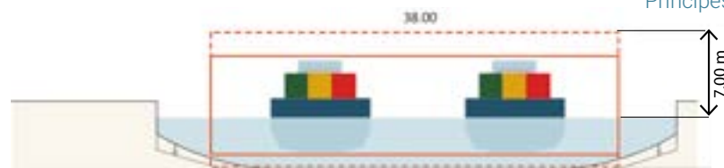
Rectangle de navigation nécessaire pour le croisement de 2 bateaux de classe Vb
